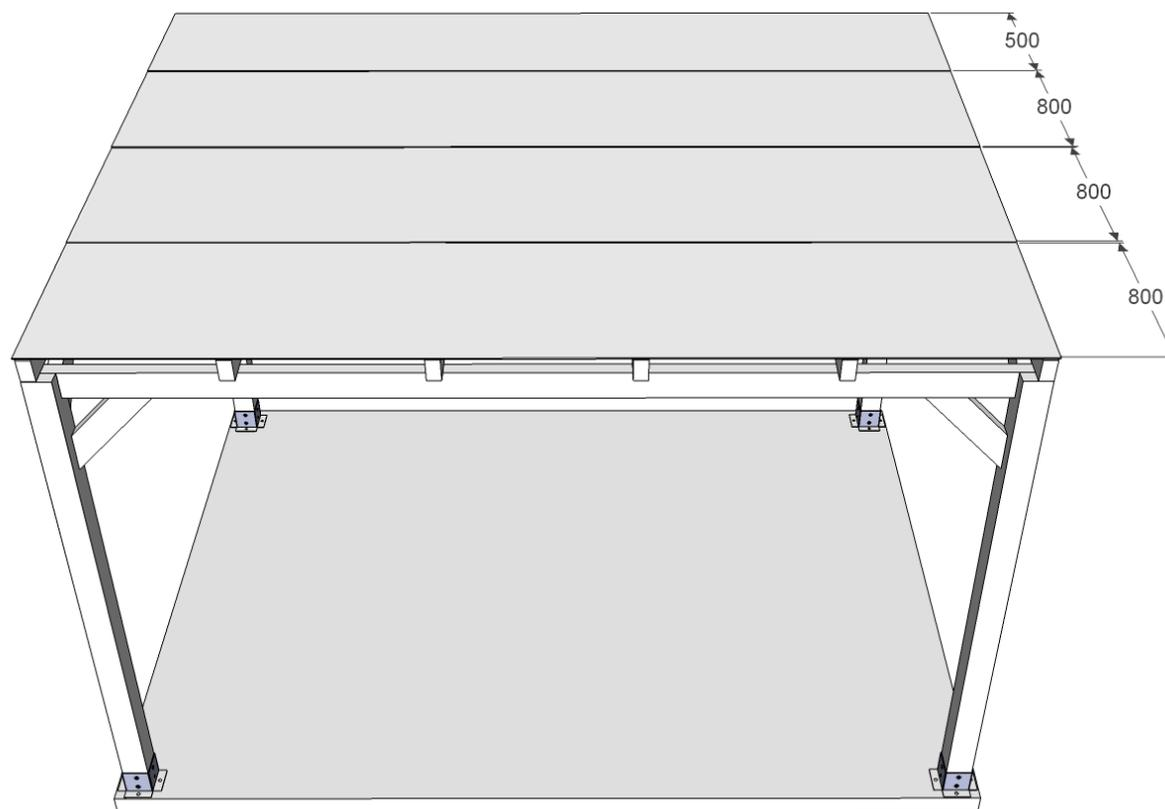
*En las siguientes imágenes el espesor de la tela asfáltica se ha exagerado para que se aprecie claramente el montaje en forma de escalera, iniciando la instalación de la tela por la parte más baja de la pérgola, para que el agua discorra sin filtraciones. Montamos de unos 10 cm sobre la anterior tela asfáltica.*
