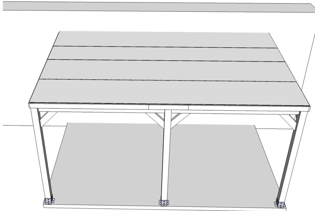
*El montaje es en forma de escalera, iniciando la instalación de la tela por la parte más baja de la pérgola, para que el agua discurra sin filtraciones. Montamos de unos 15 a 20 cm sobre la anterior tela asfáltica solapandolas.*
