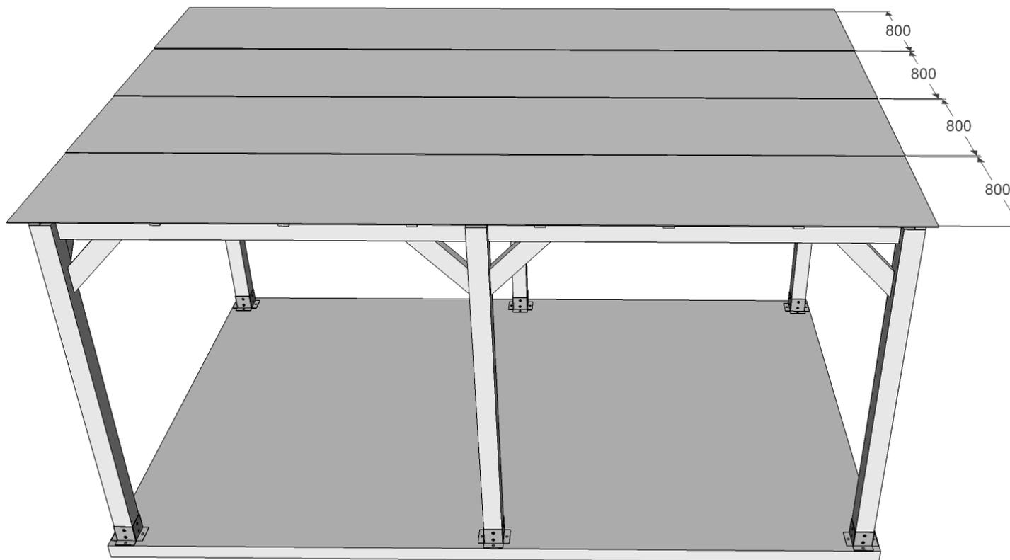
*En las siguientes imágenes el espesor de la tela asfáltica se ha exagerado para que se aprecie claramente el montaje en forma de escalera, iniciando la instalación de la tela por la parte más baja de la pérgola, para que el agua discorra sin filtraciones. Montamos de unos 10 a 20 cm sobre la anterior tela asfáltica.*
