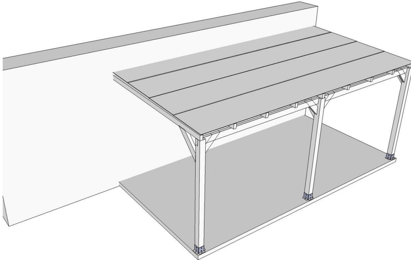
*En las siguientes imágenes el espesor de la tela asfáltica se ha exagerado para que se aprecie claramente el montaje en forma de escalera, iniciando la instalación de la tela por la parte mas baja de la pèrgola, para que el agua discorra sin flitraciones. Montamos de unos 15 a 20 cm sobre la anterior tela asfáltica.*
