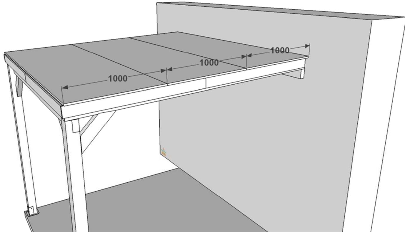
En las siguientes imágenes el espesor de la tela asfáltica se ha exagerado para que se aprecie claramente el montaje en forma de escalera, iniciando la instalación de la tela por la parte más baja de la pérgola, para que el agua discorra sin filtraciones. Montamos de unos 15 a 20 cm sobre la anterior tela asfáltica.
