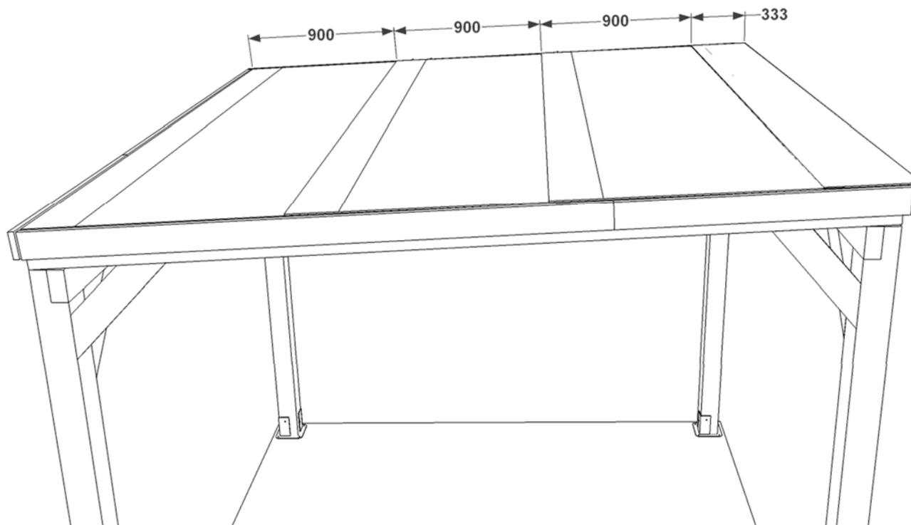
*En las siguientes imágenes el espesor de la tela asfáltica se ha exagerado para que se aprecie claramente el montaje en forma de escalera, iniciando la instalación de la tela por la parte más baja de la pérgola, para que el agua discorra sin filtraciones. Montamos de unos 10 cm sobre la anterior tela asfáltica. Colocar en forma de escalera pisando el anterior escalón.*
