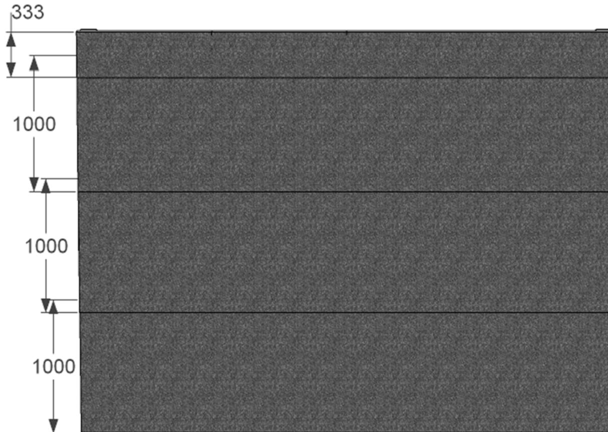
*En las siguientes imágenes el espesor de la tela asfáltica se ha exagerado para que se aprecie claramente el montaje en forma de escalera, iniciando la instalación de la tela por la parte más baja de la pérgola, para que el agua discurra sin filtraciones. Montamos de unos 10 cm sobre la anterior tela asfáltica.*
