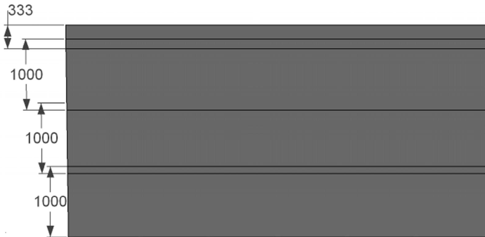
*En las siguientes imágenes el espesor de la tela asfáltica se ha exagerado para que se aprecie claramente el montaje en forma de escalera, iniciando la instalación de la tela por la parte más baja de la pérgola, para que el agua discorra sin filtraciones. Montamos de unos 10 cm sobre la anterior tela asfáltica.*
